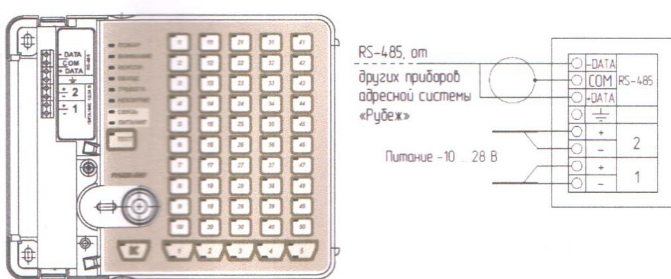
Рисунок 1 - Внешний вид и способ подключения прибора
